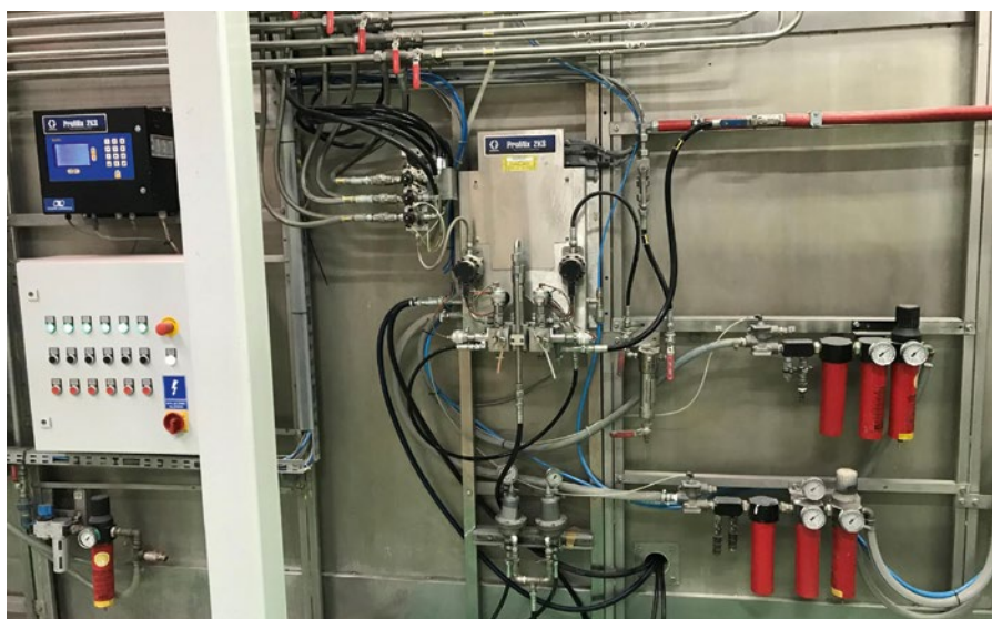
⬆ Dozownik materiałów dwukomponentowych ProMix™ 2KS.
