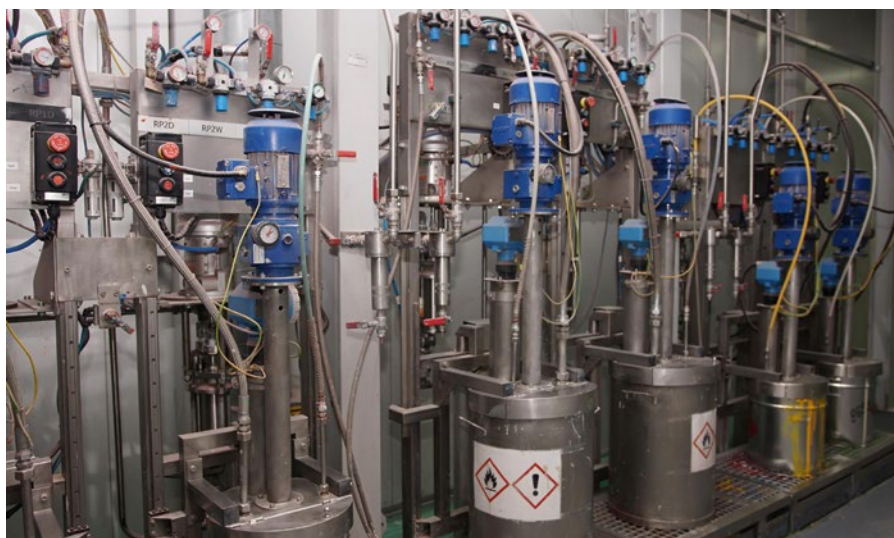
⬆ Kuchnia farb wyposażona w pompy 4 kulowe President™ 3:1 (widok od przodu).
